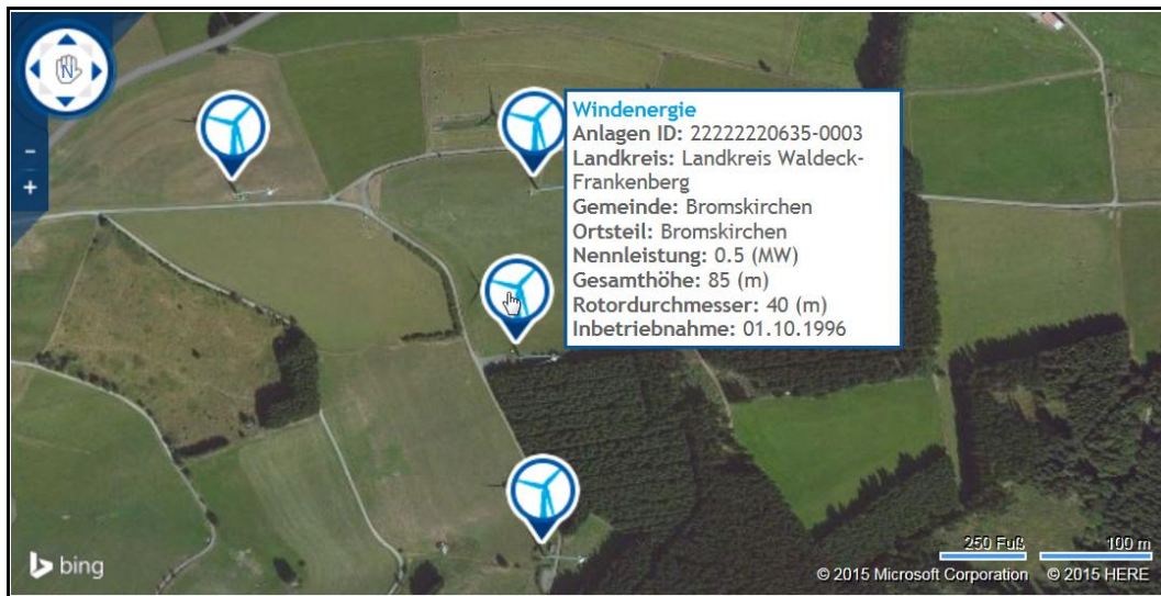
Abbildung 3 - Energiekarte: Beispielhafter Ausschnitt mit Anlageninformationen
